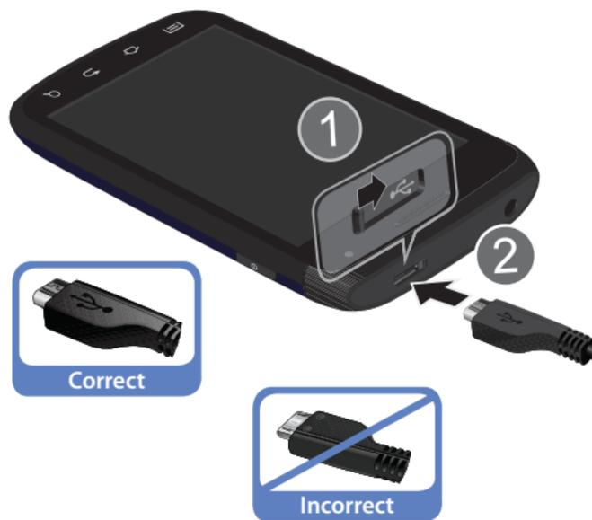
**Nota :** L'illustration ci-dessus montre les méthodes **correcte** et **incorrecte** de brancher le chargeur. Un branchement inadéquat peut endommager la prise. Aucun dommage causé par une mauvaise utilisation n'est couvert par la garantie.
